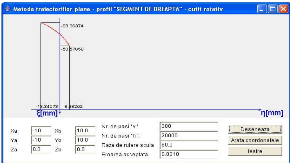
Fig. 5.41. Applet - metoda traiectoriilor plane; cuțit rotativ; profil modelat "segment de dreaptă"
